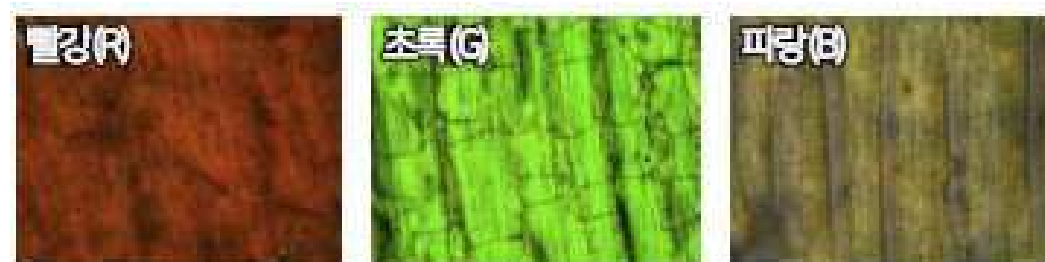
▲ AzoPDMS에 도포된 R/G/B Silica 광유리의 광학현미경 사진
